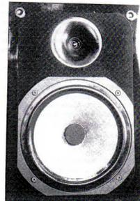
Vue de proximité des deux haut-parleurs équipant la Leedh Psyche. On remarquera au fond du pavillon en élastomère, l'inclinaison de quelques degrés de l'élément transducteur vers l'intérieur. Au centre de la membrane du haut-parleur grave-médium, le tampon de feutre en lieu et place du cache nœud évite bien des sonorités nasillardes.
