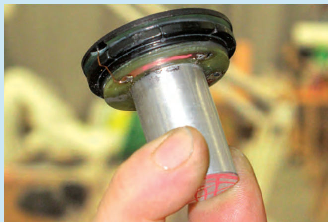
Vue du tweeter de type hybride avec dôme de 2,2 cm de diamètre en fibres de carbone suspendu par un fin jonc élastique, le circuit magnétique est sans fer à partir de secteurs usinés directement dans le néodyme pour la bague centrale et celle périphérique. A noter le tube arrière fermé servant de chambre amortissante.
