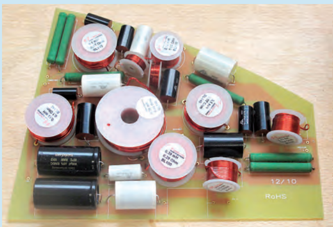
Vue des éléments du filtre logés dans le pied de la Leedh C. Le coffret renfermant le filtre servant de base est moulé dans l'usine.
