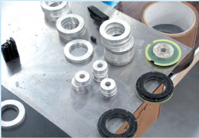
Les différents gabarits pour la réalisation des supports de bobine et des aimants. Pas moins de 5 kg d'aimant sont utilisés au total en terre rare néodyme/fer/bore.
