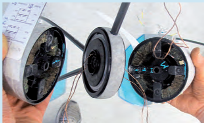
Assemblage des deux modules de grave en opposition formant un coffret saladier accueillant moteur et liaisons électriques.
