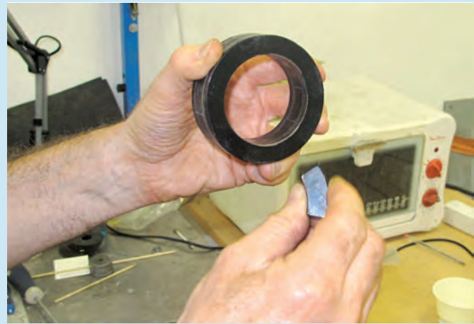
Assemblage des portions d'aimant néodyme pour la structure externe à la bobine mobile, une autre structure interne reçoit l'assemblage d'aimants magnétiques orientés radialement par secteur et axialement par bague
